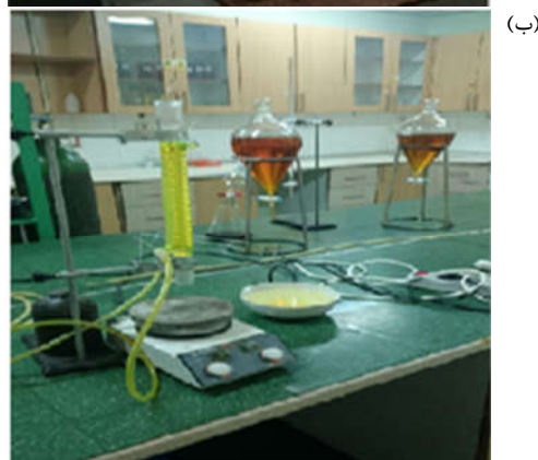
شکل ۱ - فرآیند تولید بیودیزل (الف) واکنش تبادل استری (ب) بیودیزل تولید شده از روغن ماهی
