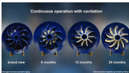
شکل ۳- تاثیر گذر زمان بر پدیده کاویتاسیون بر روی پره‌های پمپ [۳]
