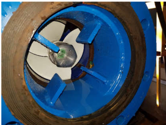
شکل ۸- محل نصب ایندیوسر که مطابق شکل بعد از پره های ضد گرداب ۱ قرار دارد
