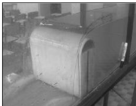
الف) سرریز تاج دایره‌ای بدون زبری در حال آزمایش
