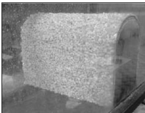
د) سرریز نصب شده در فلوم با زبری D_{50} = 4/75 \text{ mm}
