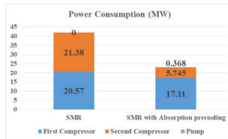
شکل ۴- میزان توان مصرفی در تجهیزات مختلف چرخه‌های مبرد چندجزئی با پیش‌سرمایش جذبی و بدون پیش سردکن
