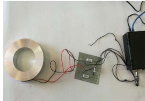
شکل ۵- کرنش سنج نصب شده بر روی سطح مماسی نمونه
