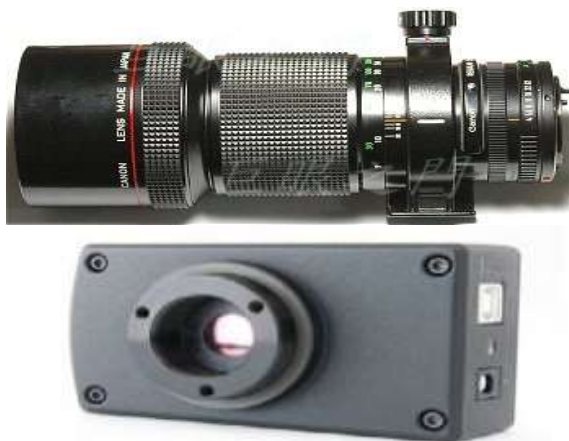
شکل ۳۰: لنز ۳۰۰ میلی‌متری Cannon و دوربین 175 lu استفاده شده برای آشکارسازی Vega
