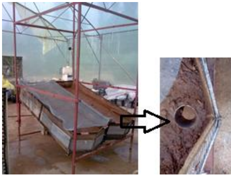
شکل ۱. نمایی از فلوم‌های آزمایشی پس از اعمال باران و خروجی رواناب
