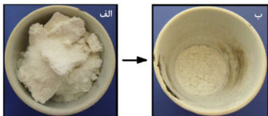
شکل ۵- نمایی از الف: رسوبات جمع شده از کف سینی و ب: مواد خروجی از کوره
