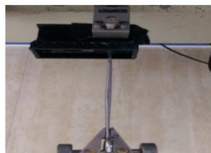
شکل ۶- قرار گرفتن ۷۰ درصد بعد سنگدانه در داخل قیر در آزمون بیرون کشیدگی سنگدانه‌ها (دو دیدگاه متفاوت)
