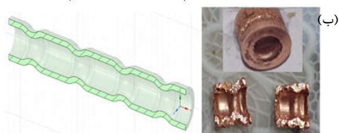
شکل ۴- انحناهای ایجاد شده در لوله‌های تبخیرکن (الف) تصویر داخلی لوله (ب) مقطع بریده شده لوله
