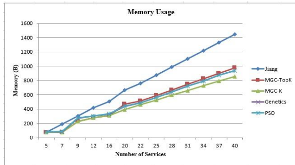
شکل ۹: نمودار مقایسه میزان مصرف حافظه روش Jiang و MGC-TopK و TopK و MGC-K و ژنتیک
