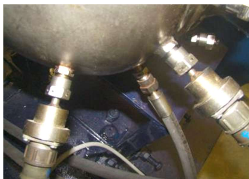
شکل ۵- نحوه‌ی نصب حس گرها روی سطح
