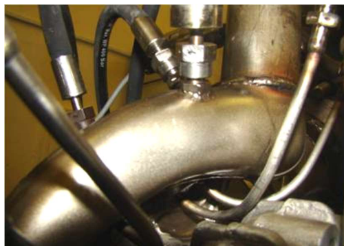
شکل ۴- اندازه‌گیری‌ها در ورود گاز به توربین
