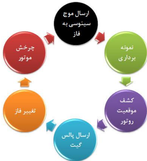
شکل ۱۴: بلوک دیاگرام نحوه اجرای پروژه
