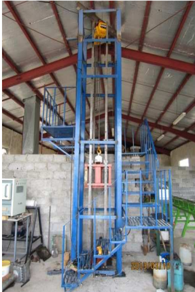
شکل ۱۰- دستگاه آزمون ضربه توسط ضربه رها شونده
