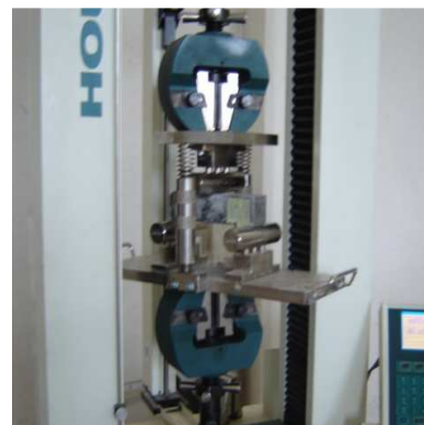
شکل ۹- دستگاه آزمون مقاومت خمشی
