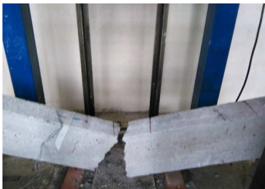
شکل ۱۳- شکست تیر بتنی حاوی ذرات لاستیک تحت آزمون ضربه با وزنه رها شونده
