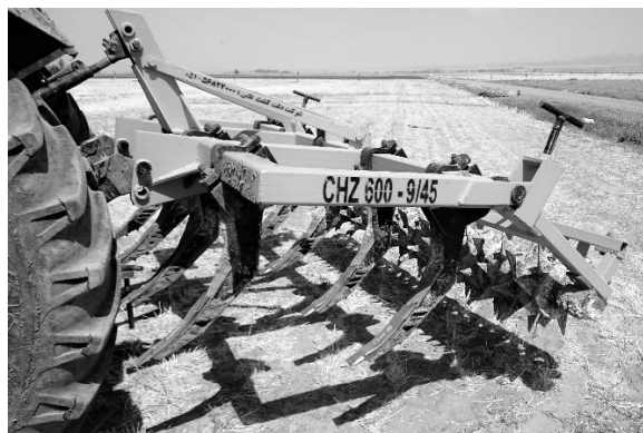
شکل ۱- دستگاه ردیفکار پنوماتیک کشت مستقیم (راست) و دنباله بند چیزل پکر (چپ)
