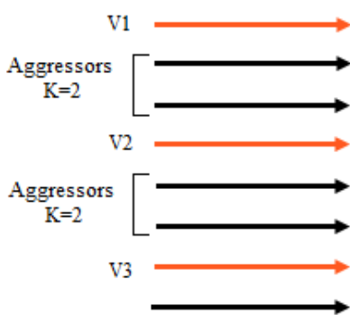
شکل ۲: آزمایش سه خط قربانی در مدل MVT
