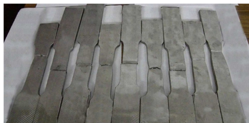
شکل ۴- قطعات جوشکاری شده پس از تست کشش
