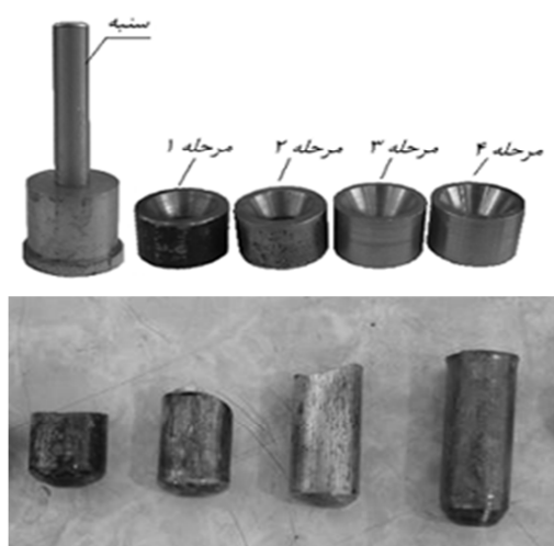
شکل ۴- اجزای چهار مرحله قالب اتوکاری به همراه نمونه‌های تولیدی قالب‌های اتوکاری (به ترتیب از چپ به راست)
