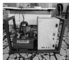
شکل ۶- تجهیزات سیستم هیدرولیکی تأمین فشار و مدار اعمال و کنترل فشار
