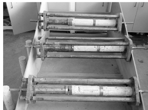
شکل ۱- دستگاه آزمایش خزش و نمونه‌های مربوطه
