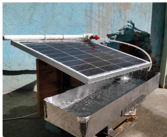
شکل ۱- نمونه آزمایشگاهی سیستم خنک‌کننده آبی پنل خورشیدی طراحی و ساخته شده در این مطالعه
