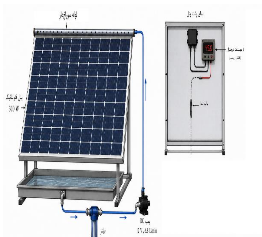
شکل ۲- طرحواره مسیر گردش آب در سامانه طراحی و ساخته شده در این مطالعه
