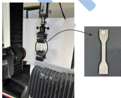
شکل ۴- نمایی از فرآیند انجام آزمون کشش بر روی نمونه‌های استاندارد
