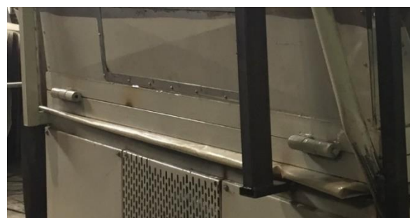
شکل ۵- پارچه برزنتی برای اتصال شاسی اصلی به شاسی فرعی Fig 5. Canvas (tarpaulin) used to connect the main frame to the vibrating frame
