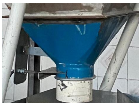
شکل ۲- دریچه قابل تنظیم در خروجی مخزن
