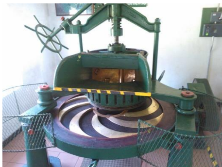
شکل ۱- دستگاه مالش صنعتی مدل ارتدکس Fig 1. Orthodox industrial grinding machine
