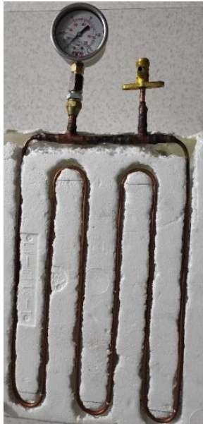
شکل ۱۰- ساختار لوله گرمائی پس از جوشکاری اکسی استیلن
