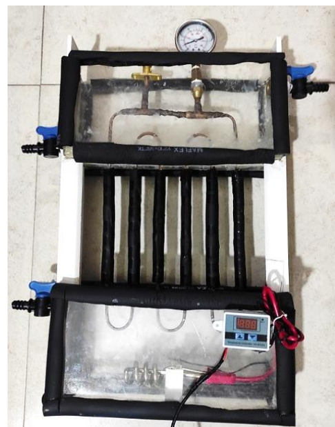
شکل ۳- دستگاه آزمایشگاهی لوله گرمائی نوسانی حلقه بسته
