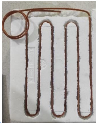
شکل ۵- ساختار لوله مسی ساخته شده مطابق اندازه طرح
