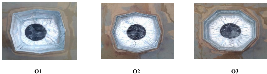
شکل ۳- نمای شرایط جریان‌های ریزشی در سرریزهای هشت‌ضلعی
