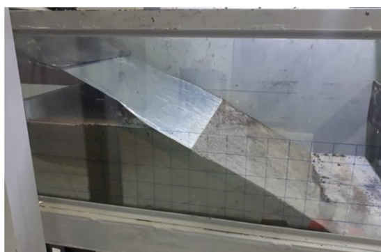
شکل 6- برش شیب‌دار لایه‌های خاک متراکم شده
