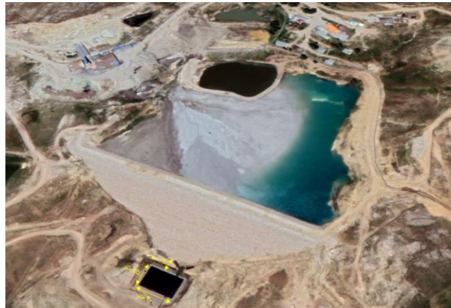
شکل ۱۲- تصویر ماهواره‌ای سد باطله و سامپ ذخیره زهاب‌های عبوری از سد در پایین دست آن (برگرفته از google earth). Figure 12- Satellite image of the tailing dam and the sump in the downstream for storing the passing drains (derived from geegle earth).
