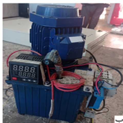
شکل 4- الف) مخزن ذخیره و گرمایش روغن حرارتی (نسوز) با المنت برقی و پمپ روغن کوپل شده، ب) الکتروموتور پمپ روغن همراه با ترموکوپل‌ها، ترموستات و رله SSR
