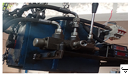
شکل 3- الف) اجزای شفت‌های کشش، کفه‌ها و جک بارگذاری، ب) ترکیب شفت‌ها و کفه‌های دوجداره در محفظه، پ) و ت) سیستم هیدرولیکی برای بارگذاری محصورکننده
