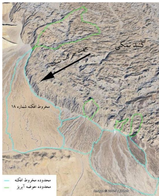
شکل (۱۰): حرکت گنبد نمکی به سمت پائین دست و مدفون کردن بخشی از مخروط‌افکنه شماره ۱۸ در حاشیه گنبد نمکی شاه‌غیب Figure (10): Downslope Movement of Salt Dome and Burying Parts of Alluvial Fan 18 Around the Shah Ghayeb Salt Dome
