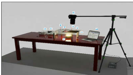
شکل ۳- شماتیک چیدمان آزمایش: الف) لپ‌تاپ، ب) ظرف برای جمع‌آوری مایع مصرفی، پ) میکسر Y شکل، ت) قطرات فلز مایع جیوه، ث) دوربین دیجیتال، ج) مخازن ورودی پر شده با محلول هیدروکسید سدیم با غلظت ۰/۳ مول بر لیتر، چ) سیم مسی، ح) اسیلوسکوپ، خ) مولد سیگنال، د) منبع نوری
