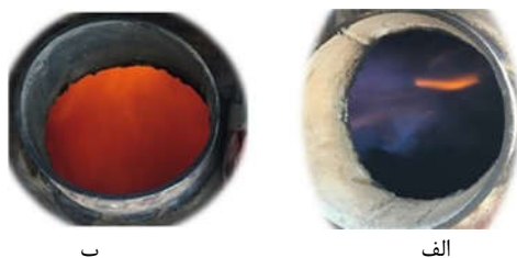
شکل ۹- رنگ شعله (الف) در حالت بدون تزریق افزودنی (ب) در حالت با تزریق افزودنی
