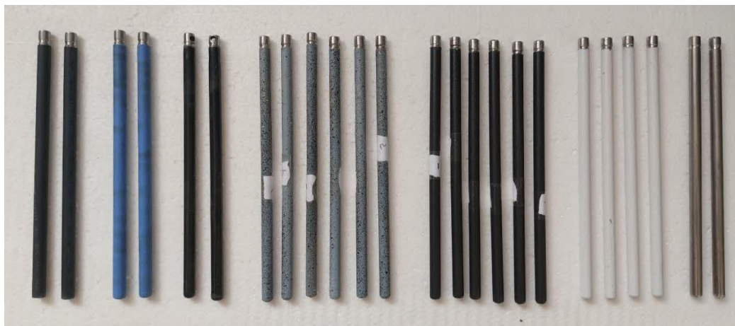
شکل ۳- مواد مختلف مورد استفاده برای پوشش میله‌های حسگر تماسی دستگاه TDR (از راست به چپ به ترتیب میله‌های بدون پوشش، پوشش رنگ کوره، پوشش تفلون، پوشش گرانیات، پوشش لعاب و پوشش شرینگ آبی و سیاه رنگ).
