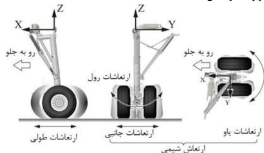
شکل ۱- نمایی از نوسانات سیستم تعلیق دماغه هواپیما [۱۹]
