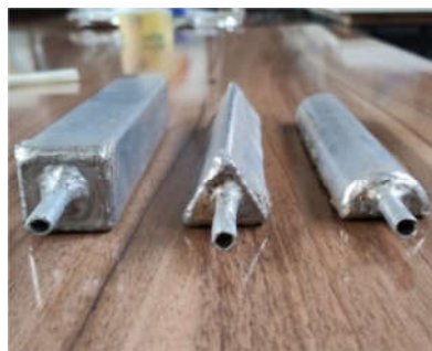
شکل ۲- کانال های با مقطع مربعی و مثلثی و نیم دایره
