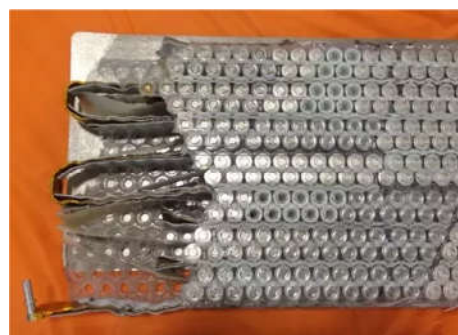
شکل ۹- ماژول باز و بررسی شده خودرو Tesla با سلول ۱۸۶۵۰.
