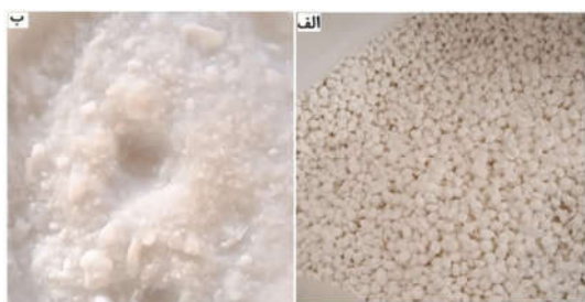
شکل ۱- مواد اولیه مورد استفاده الف. گرانول پلی لاکتیک اسید ب. نانوذرات ۲۰-۳۰ نانومتری سیلیکا
