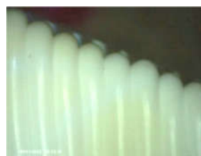
شکل ۱۱- تصویر میکروسکوپی از سطح قطعه چاپ شده
