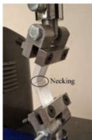
شکل ۱۰- گلوبی شدن در تست کشش نمونه زانویی
