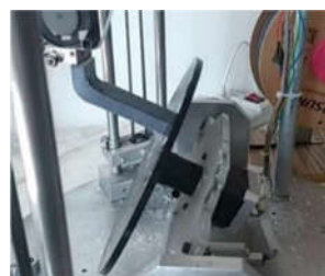
شکل ۸- چاپ قطعه نمونه بدون تکیه‌گاه (پنج‌محور)
