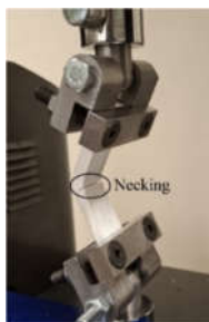
شکل ۱۰- گلوبی شدن در تست کشش نمونه زانویی
