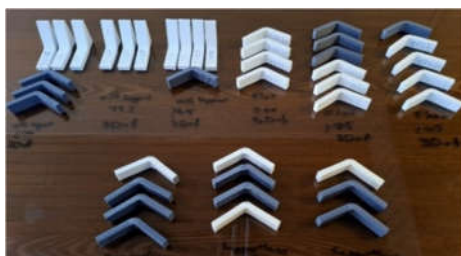
شکل ۹- نمونه قطعات چاپ شده به سه روش
