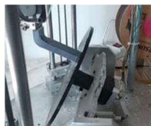
شکل ۷- چاپ قطعه نمونه در حالت خوابیده (سه‌محور)
