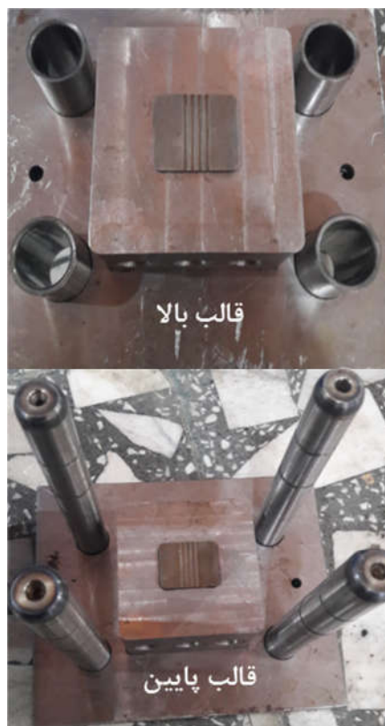
شکل ۲- مجموعه قالب استفاده شده در آزمایش‌های تجربی
