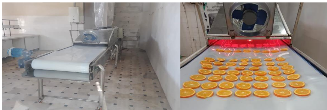
شکل ۱- نمایی از خشک کردن برش های پرتقال در دستگاه رفراکتانس ویندو
