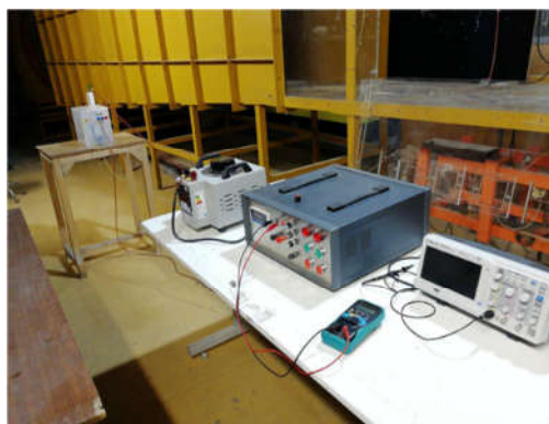
شکل ۴- نمای بیرونی از دستگاه منبع تغذیه پلاسما به همراه دستگاه‌های اندازه‌گیری الکتریکی
