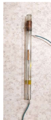
شکل ۲- تصویر نمونه ای از جت پلاسمای ساخته شده
