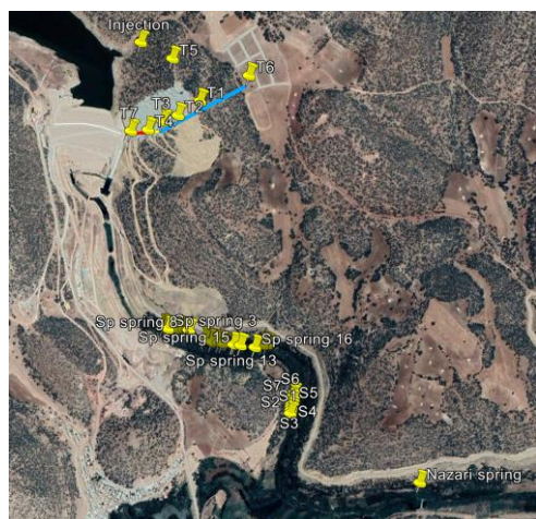
شکل ۶: محل نقطه تزریق ردیاب و نقاط نمونه‌برداری.
