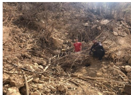
شکل ۳: فرو افتادگی به شکل فروچاله در پایین دست گمانه
