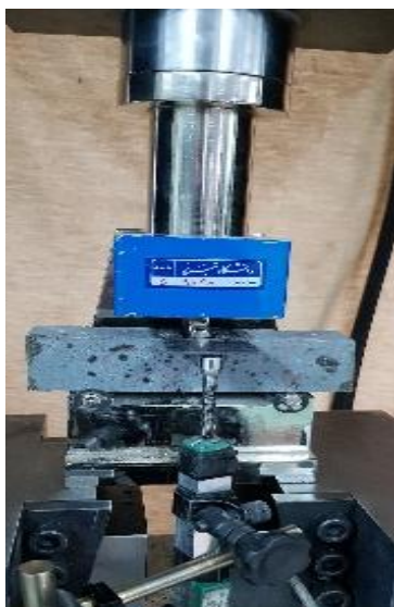
شکل ۶: چینش آزمایش مقاومت خمشی
