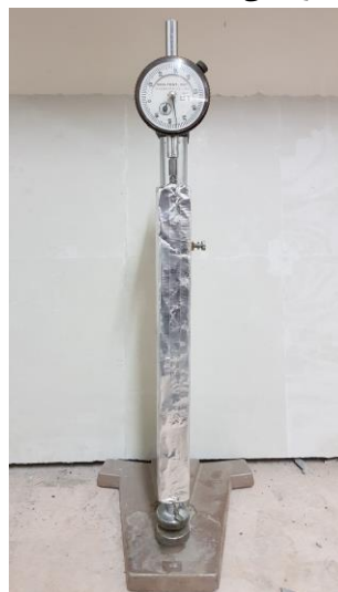
شکل ۳: چینه‌ش آزمایش نمونه جمع شدگی خودزا
