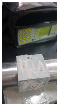
شکل ۱۵: چینه‌ش آزمایش سرعت پالسی
