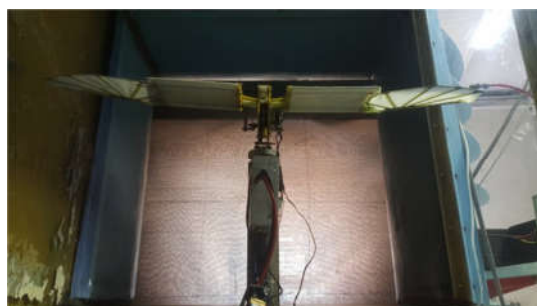
شکل ۵- نمای داخلی محفظه آزمون تونل باد زیر صوت دانشگاه صنعتی امیرکبیر و مدل نصب شده در آن
