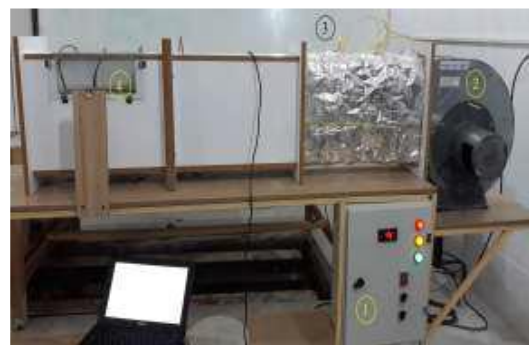
شکل ۱- نمای خشک کن هوای داغ همرفتی، ۱) واحد کنترل الکتریکی ۲) پنکه ۳) المنت های حرارتی ۴) سینی نمونه های میگو
