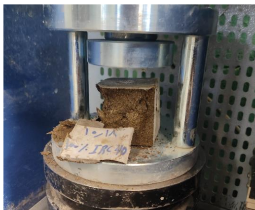
شکل ۲. تست مقاومت فشاری نمونه‌های ساخته شده و قرارگیری آنها در آون و قرارگیری در سیکل تنش حرارتی
