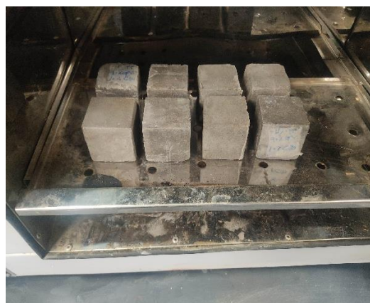
شکل ۲. تست مقاومت فشاری نمونه‌های ساخته شده و قرارگیری آنها در آون و قرارگیری در سیکل تنش حرارتی
