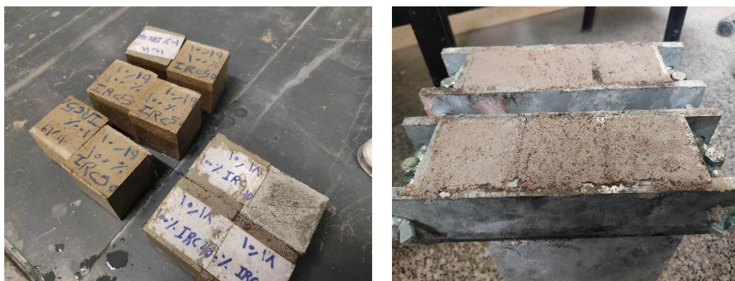
شکل ۱. نمونه گیری در قالب‌های مکعبی ۵ سانتی‌متری
