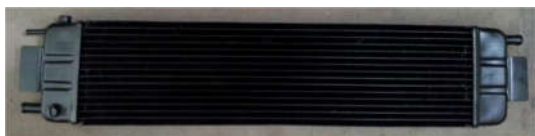
شکل ۴- مبادله‌کن گرمایی باتری استفاده شده در خودرو
