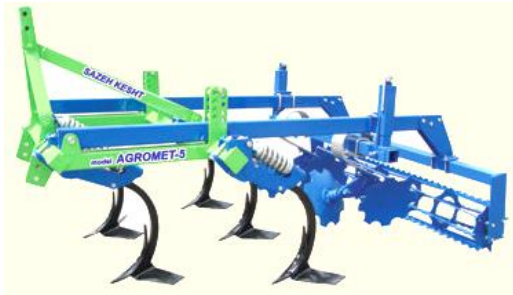
شکل ۲: خاک‌ورز مرکب مدل آگرومت ۵ شاخه ساخت شرکت سازه کشت کاوه بوکان
