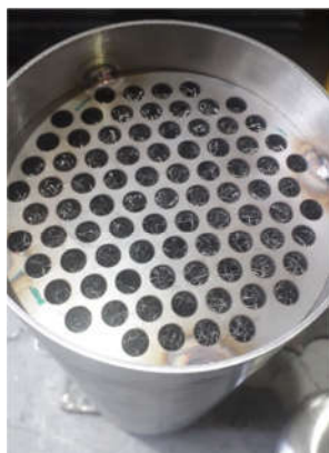
شکل ۱۱- نصب سیستم تلاطم گیر در داخل لوله استوانه‌ای
